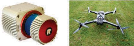
слика 1. Ласерски скенер Riegl VUX-1 и UAV беспилотна летелица Riegl Ricopter
